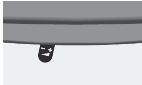
Abb. 4.10 Verbrennungslufschieber ganz nach links geschoben - Verbrennungsluft komplett geschlossen
