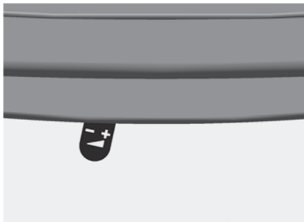
Abb. 4.5 Verbrennungsluftschieber ganz nach links geschoben – Verbrennungsluft komplett geschlossen
