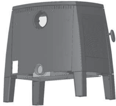
Abb. 3.1 Verbrennungsluftstutzen, unten auf der Rückseite des APELLA
