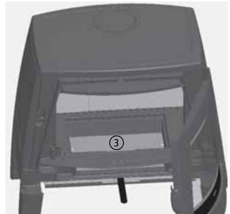
Abb. 6.20 Bodenblech / Ascheraum reinigen
