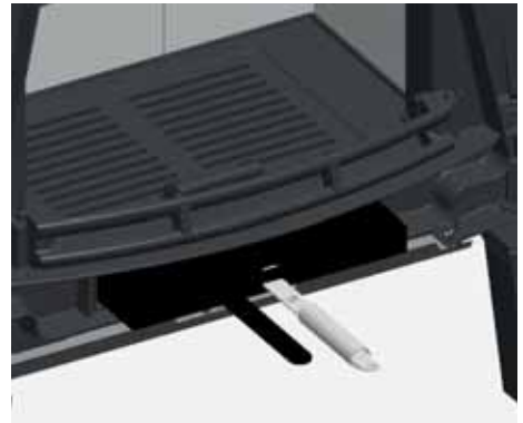
Abb. 6.8 Aschekasten mit Bediengriff herausziehen
